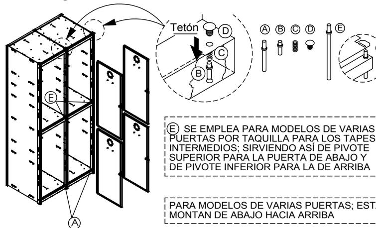
(E) SE EMPLEA PARA MODELOS DE VARIAS PUERTAS POR TAQUILLA PARA LOS TAPES INTERMEDIOS; SIRVIENDO ASÍ DE PIVOTE SUPERIOR PARA LA PUERTA DE ABAJO Y DE PIVOTE INFERIOR PARA LA DE ARRIBA
